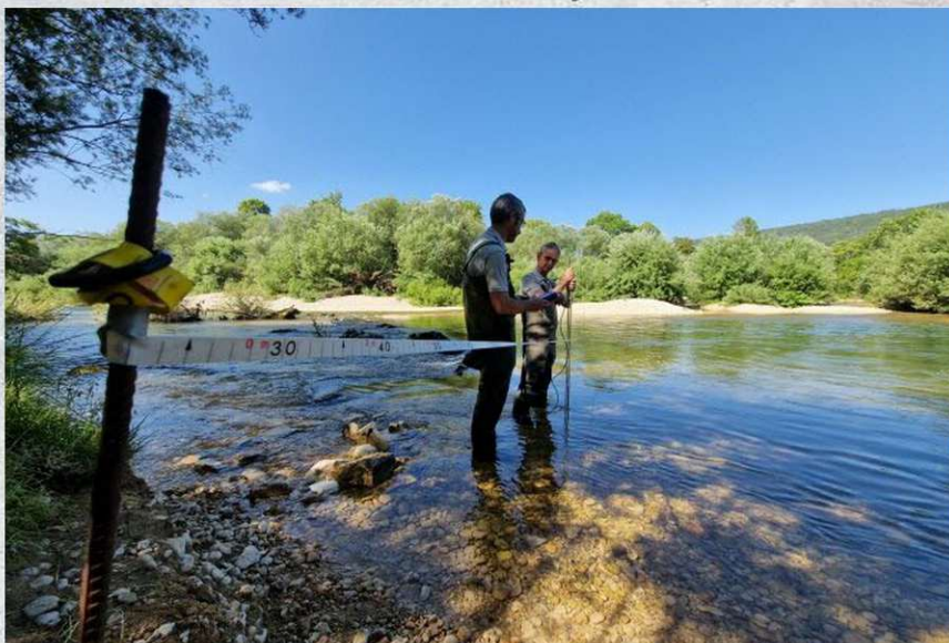
Plusieurs points de repères sont pris pour mesurer le débit. Photo Progrès/Vincent DURAND
