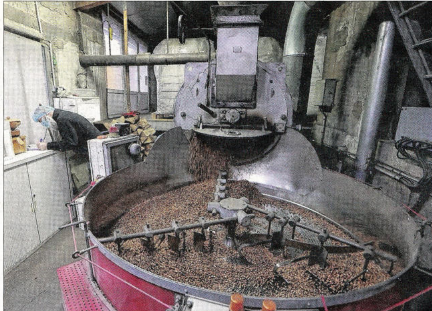
Parmi les secrets de fabrication : la torréfaction au feu de bois, entre 150 et 200 °C, à raison de 150 kg de grains toutes les 20 minutes. Photo ER/Ludovic LAUDE
